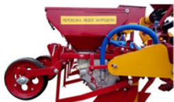
модификация сошника (К, КУ) для посева кукурузы и подсолнечника
