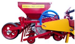
модификация сошника для посева овощных культур (свекла, соя, лук, морковь и др.)
