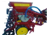
модификация сошника (Д, ДУ) для посева пропашных культур на тяжёлых почвах
